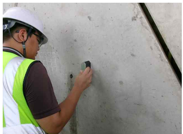
경사계를 이용한 경사도 측정
